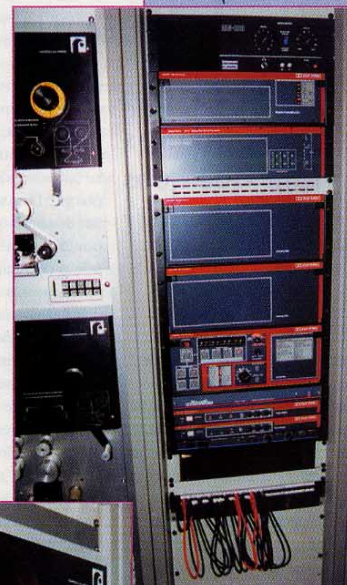
Le rack Dolby. On y voit de haut en bas les différents décodeurs: Dolby A, Dolby Pro-Logic (numérique) et Dolby SR.
