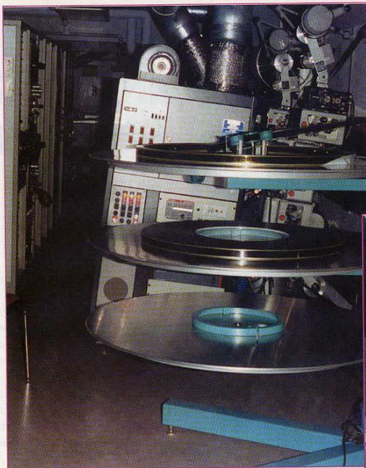
Vue d'ensemble de la cabine de projection. Le film ainsi que les bandes-annonces et les publicités partent du plateau du haut vers le projecteur puis retournent vers le plateau du milieu.
