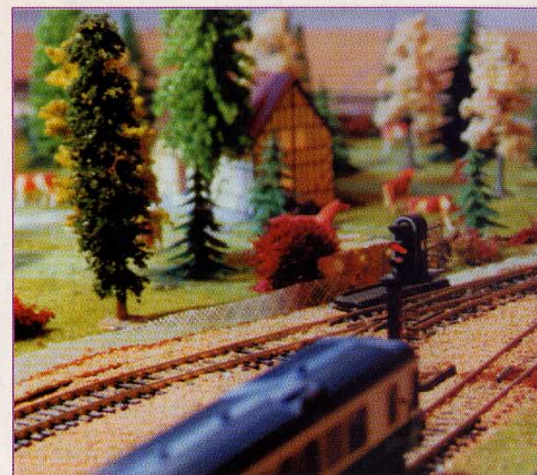
Feu rouge, le train est à l'arrêt. On peut repérer le capteur ILS placé dans l'axe de la voie au niveau du signal.
