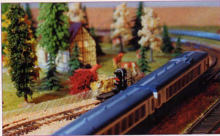
Le train ayant dépassé le capteur ILS, le feu repasse au vert.
