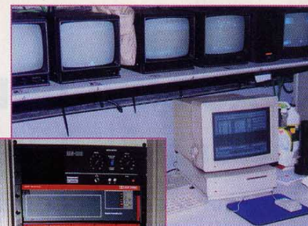
L'ordinateur pilotant les événements des trois salles de cinéma. Les différents moniteurs permettent le contrôle de l'image et des projecteurs.
